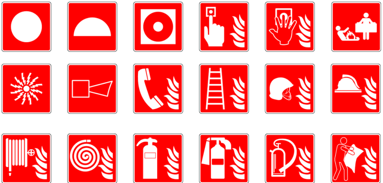
Figura 6. Señalización equipos de protección contra incendios.
