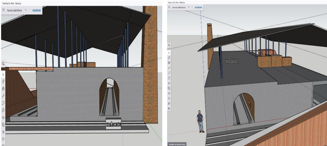
Nota: 7. Autoría propia, en la parte superior de la ilustración se divisa el muro que separa la arena del riel, en la parte inferior izquierda se observa la salida del horno donde mayormente suceden los incidentes y la parte inferior derecha se divisa la salida de la secadora y el ingreso del horno; adicionalmente se logra divisar la zona donde va el distribuidor de carbón Y, denotando los ocho orificios de inyección.
