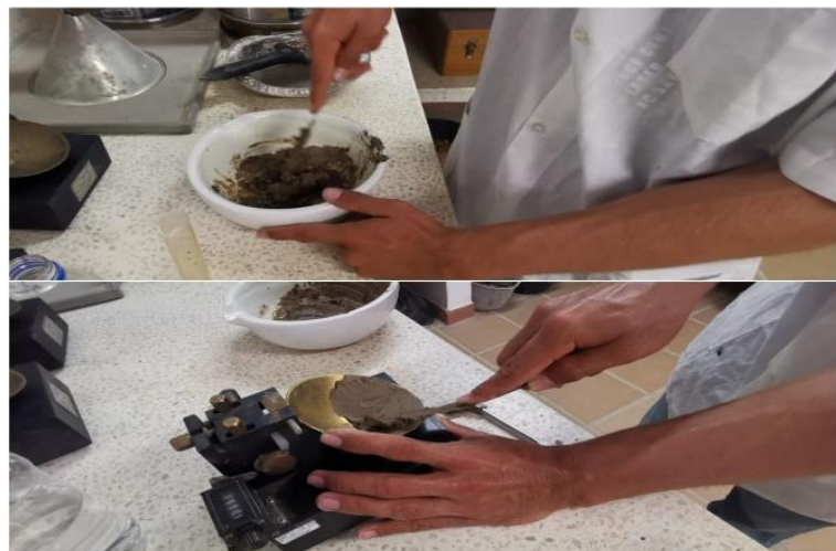
Ilustración 8, Ensayo límite líquido, preparación de la muestra, cuchara de Casagrande Fuente: Tarquino Javier, 2022
