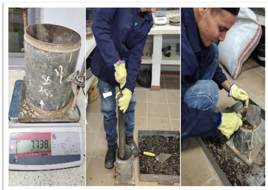
Ilustración 10, Ensayo Proctor, Peso de molde, Compactación y enrase de la muestra Fuente: Tarquino Javier, 2022
