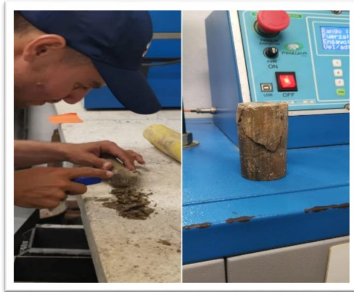
Ilustración 11, Ensayo Compresión Incofinada Fuente: Tarquino Javier, 2022
