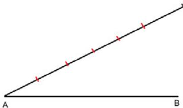
Luego, se une el último arco con el punto B mediante un segmento, para posteriormente trazar segmentos paralelos por cada uno de los arcos ubicados en la semirrecta:
