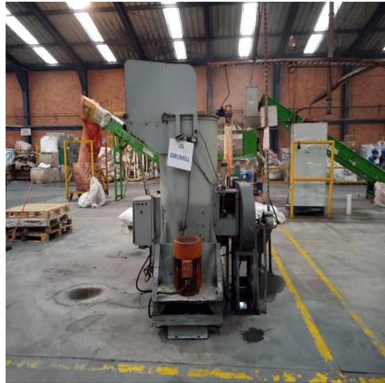
Imagen 7-8. Se relaciona la ausencia y/o falta de mantenimiento de las demarcaciones de la superficie de las áreas de trabajo.
