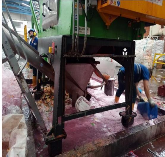
Imagen 11-12. Se relaciona el derrame de líquido retenido en el área de trabajo de otros equipos, zonas desorganizadas y los gabinetes eléctricos.
