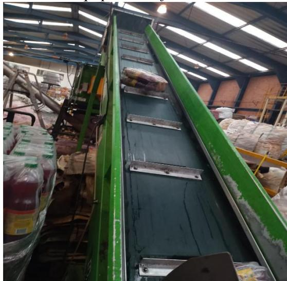
Imagen 1-2. Se relacionan la disposición de los productos provistos para la destrucción y el medio por donde son transportados-equipo tecnofer.
