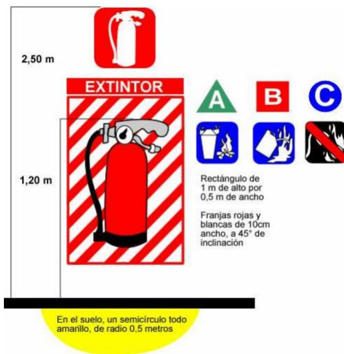
Figure 12 Ubicación de los extintores
