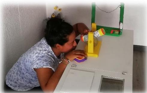
Observar por el orificio del tubo y direccionar hacia el objeto que se quiere medir, enfocar hasta su cima
