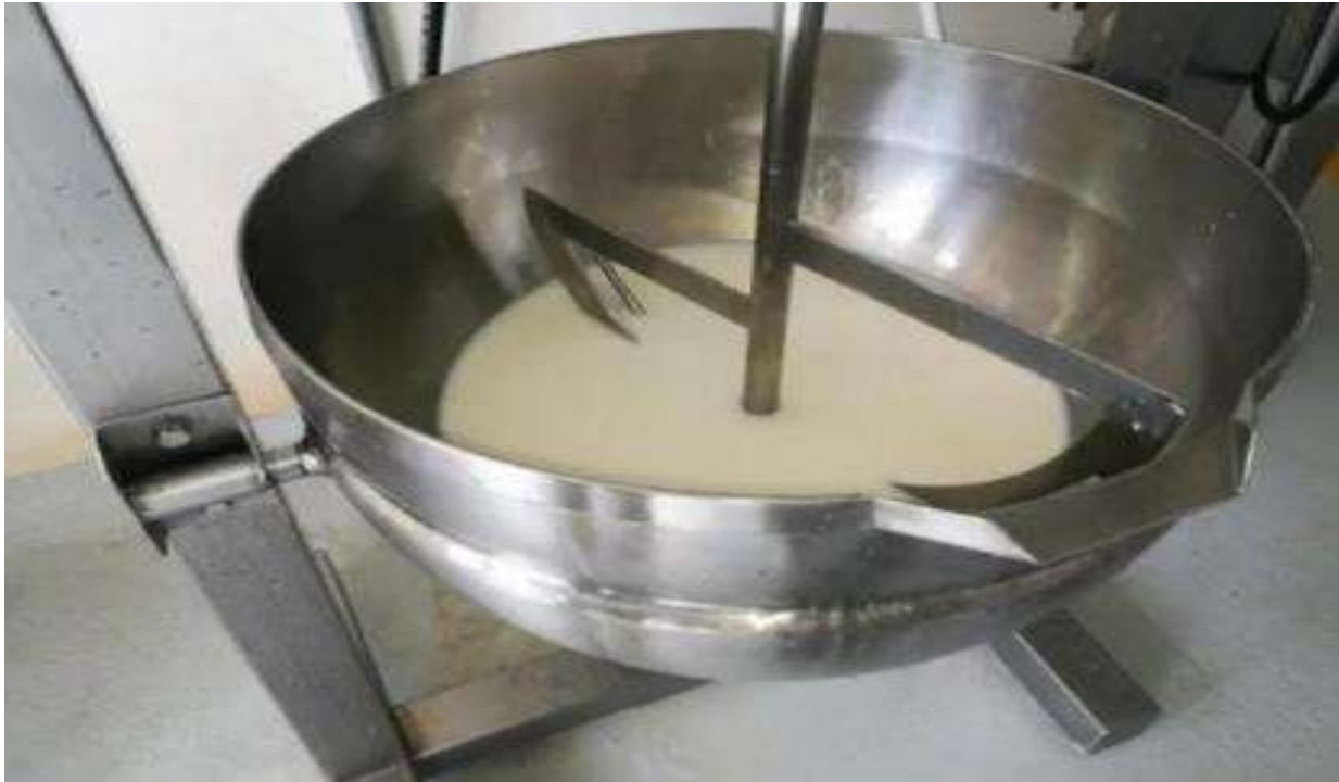
Figura 4. Marmita para el calentamiento de la leche y dar inicio del proceso del arequipe.
