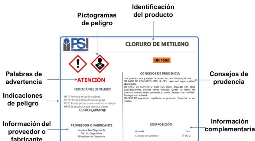
Figura 1. Este es un ejemplo para el diseño de las etiquetas de los productos químicos de acuerdo con el diseño propuesto por el SGA.
