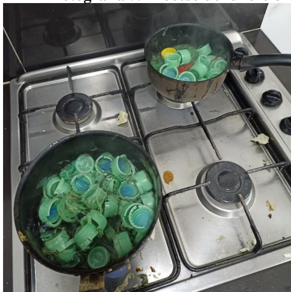
Fotografía 5. Proceso de fundición de material PET
