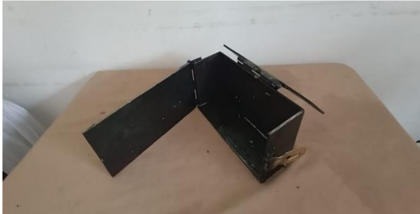
Fotografía 6. formaleta de adoquín
