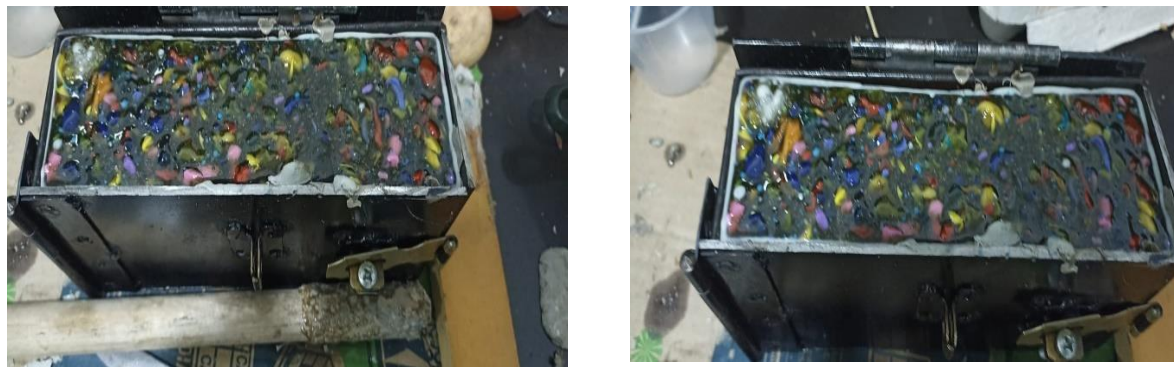
Fotografía 7. Vaciado en molde metálico y sellado
