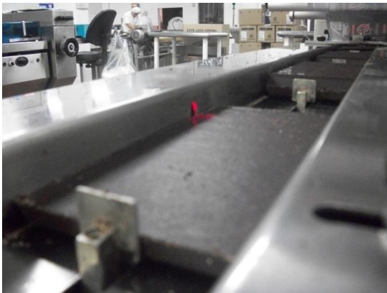
FIGURA 12. Faltante de pasta completo
