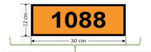
Artículo 5° B. Identificar en una placa el número de las Naciones Unidas (UN) para cada material que se transporte, en todas las caras visibles de la unidad de transporte y la parte delantera de la cabina del vehículo de transporte de carga.
