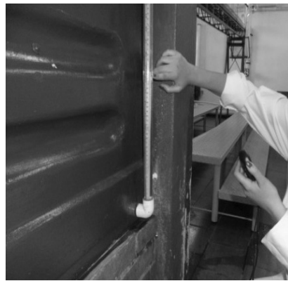
Figura 70. Aforo de volumen en piezómetro de agua.
