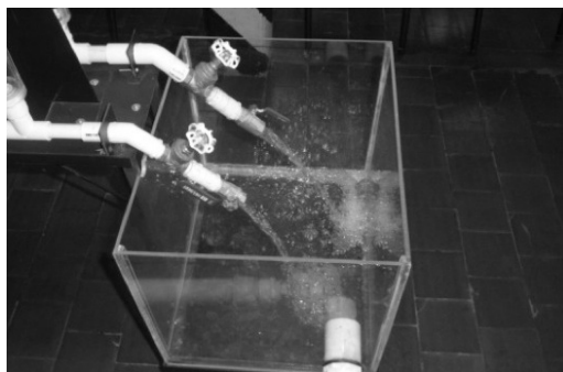
Figura 57. Tanque para aforos de caudal.
