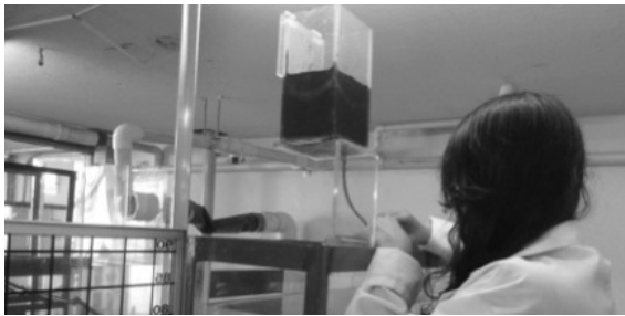
Figura 6. Inyección de tinta para visualizar tipos de flujo en la tubería transparente.
