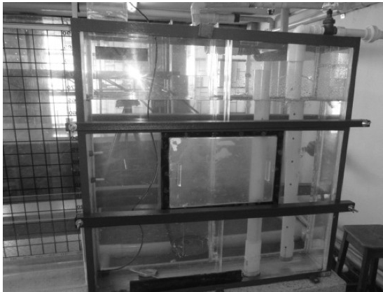
Figura 4. Tanque de rebosadero para mantener carga hidráulica constante.
