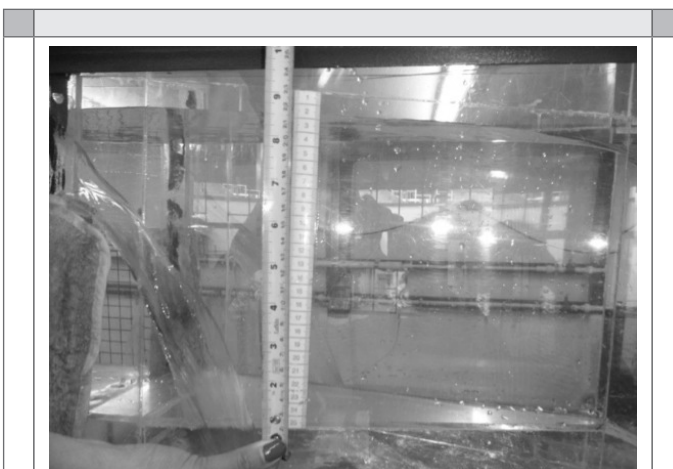
Figura 89. Profundidad a 2/3 de la garganta de la canaleta Parshall.
