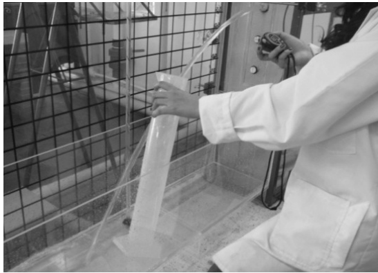
Figura 34. Aforo del caudal real para cada chorro.
