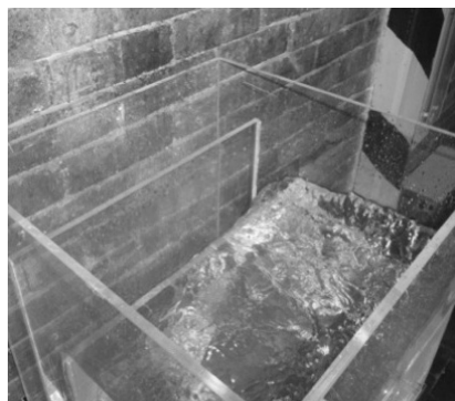
Figura 55. Tanque de carga hidráulica.
