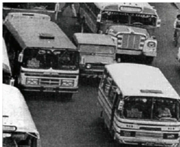
Esta fotografía muestra dos busetas Superior en medio de la carrera Décima. Este modelo de fines de los años 60 con aristas agudas y vidrios planos fue uno de los más populares de esa industria carrocería. Ver en Revista Nueva Ruta
