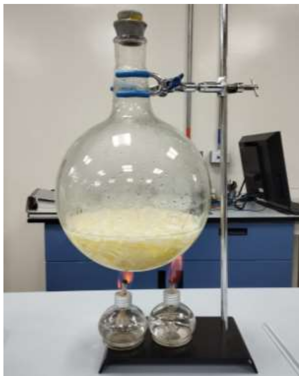
Figura 6. Proceso de escaldado de la materia prima con ayuda de balón de precipitado y mecheros
