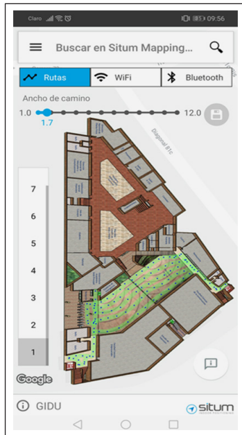
Figura 25. Grabación de huellas digitales bloques B y C, planta 1 de UNIMINUTO sede Bogotá Presencial Fuente: Aplicación Situm Mapping Tool (2018).
