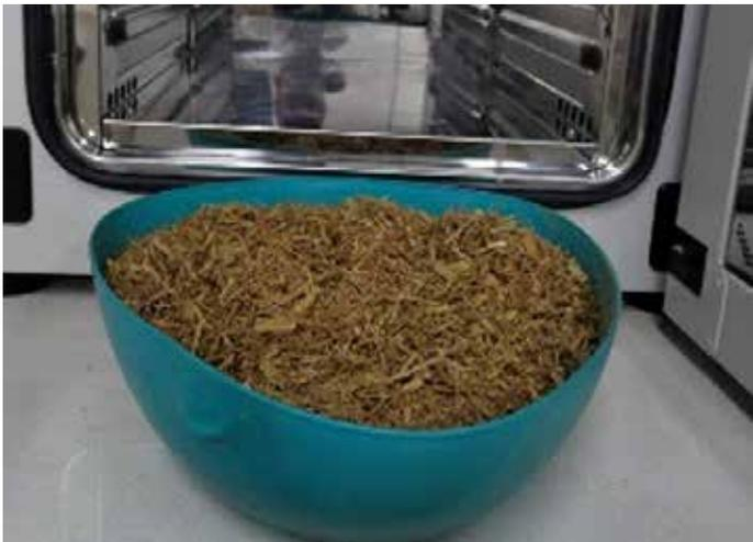
**Figura 36.** Alistamiento de material impregnado con ácido fosfórico
