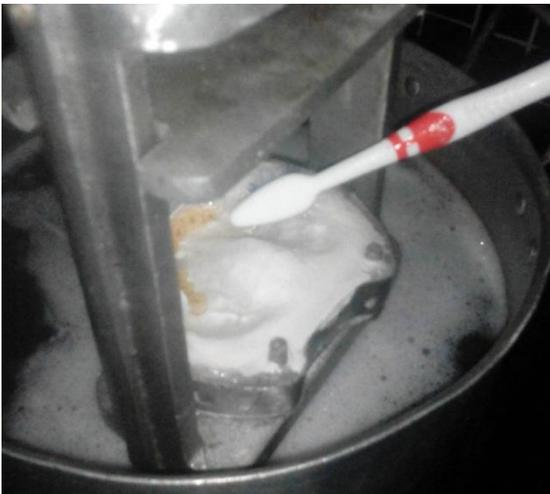
Luego de empacar el acrílico se lleva de nuevo a la olla por 45 minutos para que el acrílico sufra la termo polimerización
