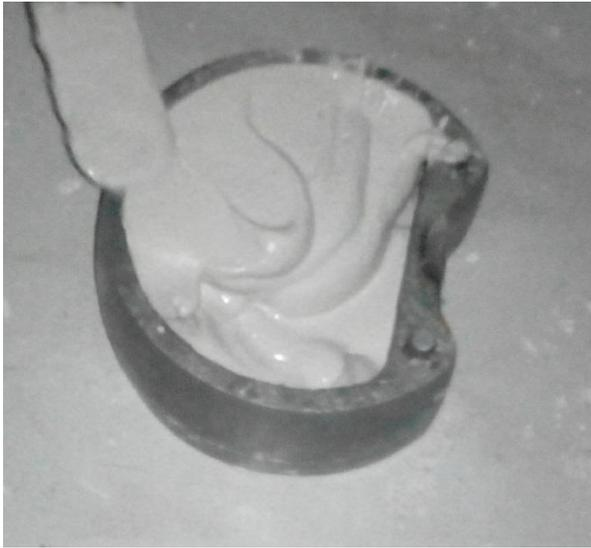
Ya después de fraguado los yesos se ponen las campanas de la mufla en la prensa y se sumergen en agua caliente para derretir la cera
