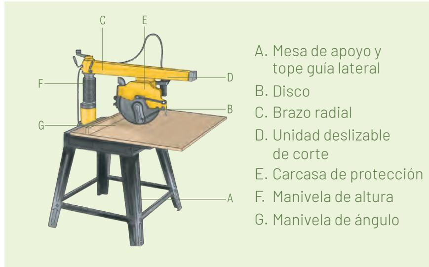
**Figura 38.** Imagen de Sierra radial. Recuperada de Manual Técnico de laminado de bambú. et al., 2020, p. 16
