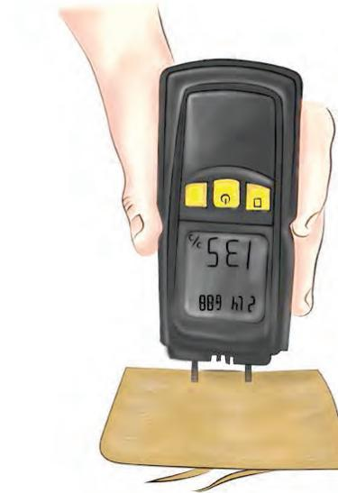
**Figura 49.** Imagen que determina el porcentaje de humedad. Recuperada de Manual Técnico de obtención de biochar de Bambú. et al., 2020, p. 15.
