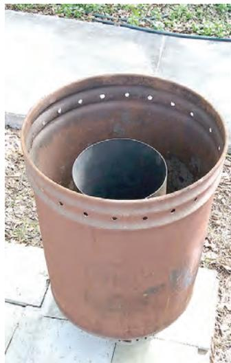
**Figura 48.** Imagen de horno pirolítico de doble tambor. Recuperada de Manual Técnico de obtención de biochar de Bambú. et al., 2020, p. 11
