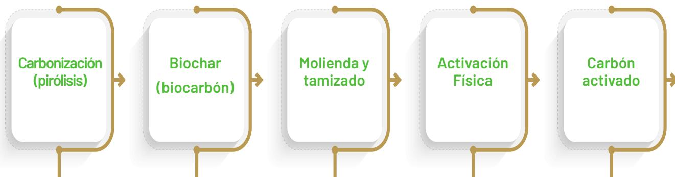
**Figura 52.** Diagrama del biochar y carbón activado
