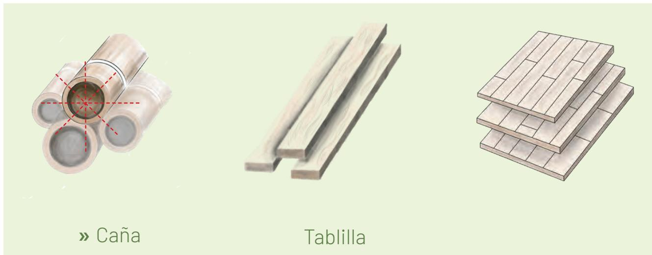
**Figura 36.** Síntesis del proceso de transformación de laminado del bambú. Imagen tomada de Manual Técnico de laminado de bambú. 2020
