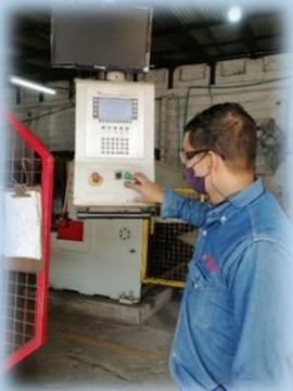
Accione la maquina y realice una prueba en vacío
