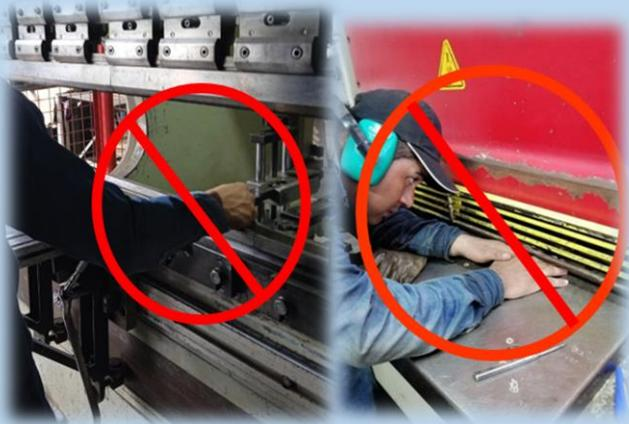
Durante la ejecución de las actividades en la maquina NUNCA ingresar partes del cuerpo después de la guarda de seguridad ni en parte móviles
