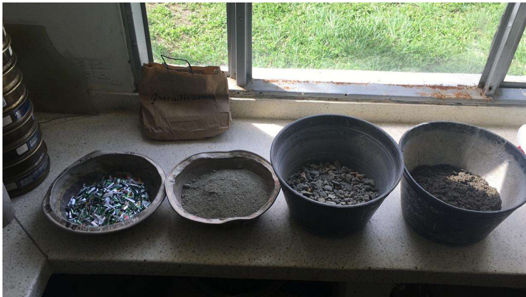
Ilustración 5. Materiales para los cilindros de concreto con adición de fibras de aluminio.
