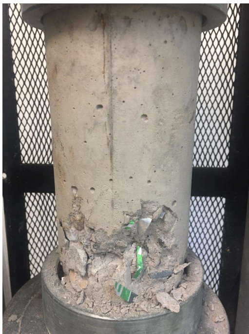
Anexo 11. Cilindro de concreto con 6% de fibra de aluminio, fallado a los 28 días.
