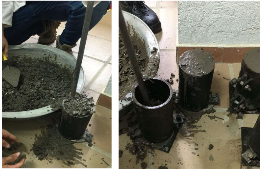
Anexo 6. Vaciando el concreto con 6% de adición de fibras de aluminio, en el cilindro.
