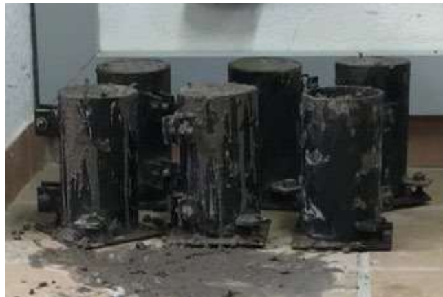
Anexo 7. Cilindros de concreto y adición del 3% y 6% de fibra de aluminio.
